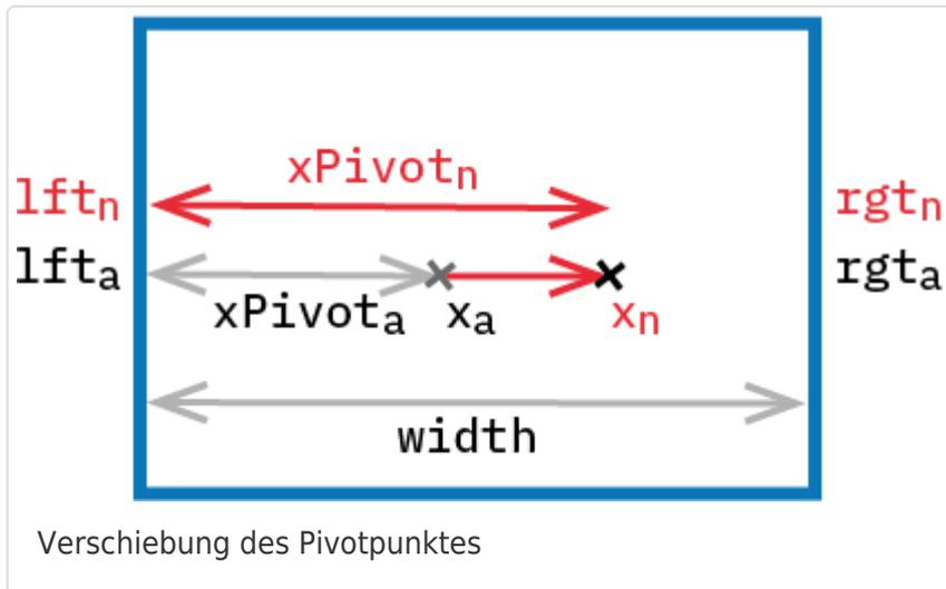
Wenn man den Pivotpunkt der Bounding Box verschieben will, ohne die Box selbst zu verschieben, muss man eine Ausgleichrechnung durchführen.
